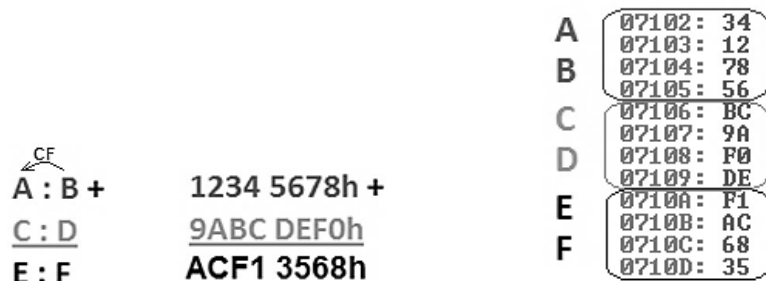
Figura 10. a) Logica programului; b) corespondența între zona de memorie și variabilele folosite în problema PR5-3
